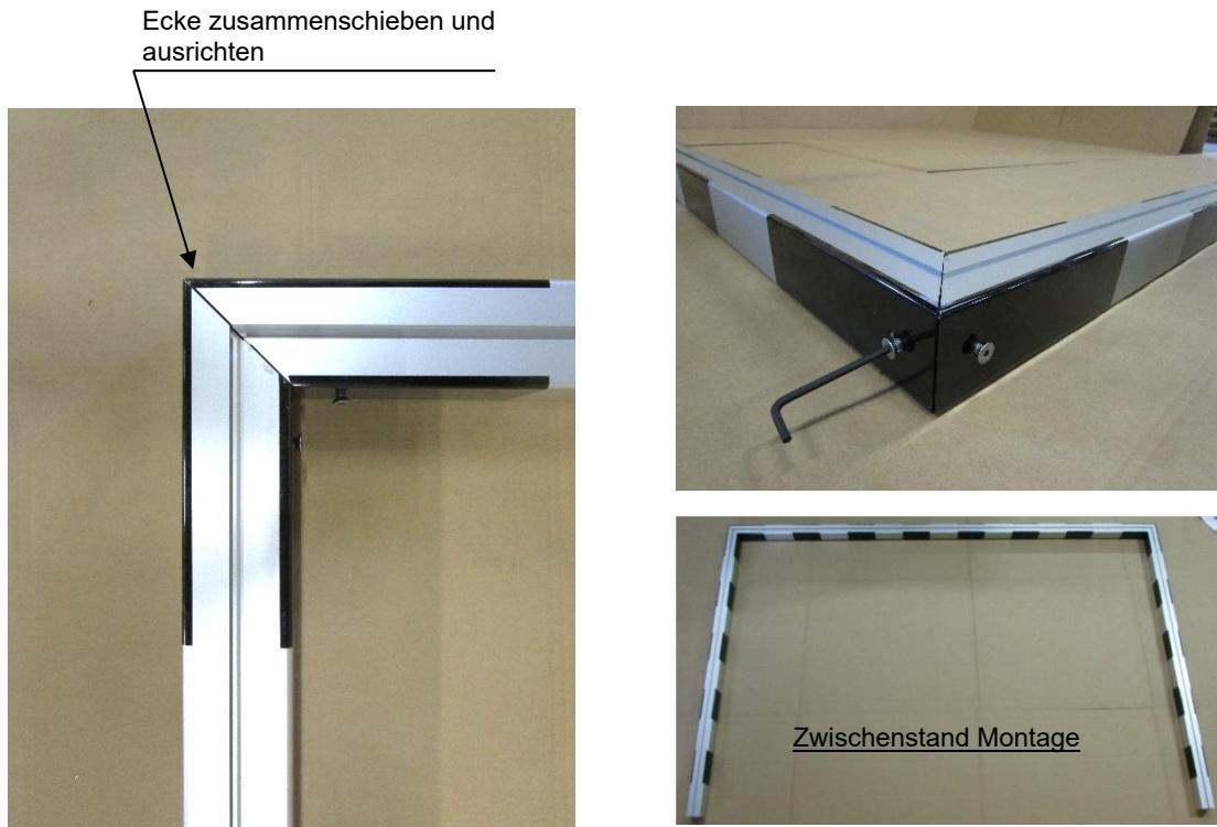
Hinweis: Aufgrund von Fertigungstoleranzen der Alu-Gusseckverbinder kann es in seltenen Fällen vorkommen, dass sich die Ecke nicht exakt ausrichten lässt. Dann die Prägungen im Pfosten mit einer Flachfeile etwas kürzen.
