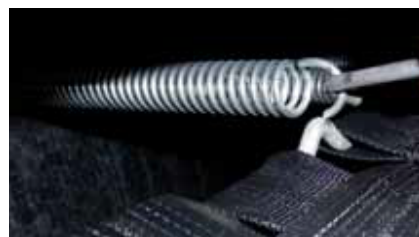
Ein- bzw. Aushängen von Federn mit Einspannhaken
