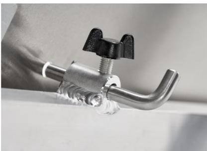
Zur Arretierung die Flügelschraube lösen, den Winkelhaken in die Bohrung am runden Seitenteil schieben und anschließend die Flügelschraube fest anziehen.
