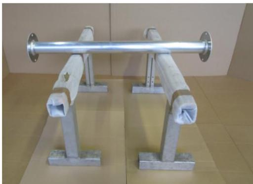
Das Haspelrohr waagrecht auf eine geeignete Hilfs-konstruktion legen (Böcke/Tisch o.ä., Höhe ca. 600 mm), sodass die Enden überstehen.
