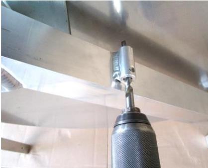
Auf einem der beiden Haspelträger ist eine Rohrhülse mit Gewinde M8 aufgeschweißt. Durch die Hülse hindurch mit einem Bohrer  $\varnothing$  9,5mm eine Bohrung für die Arretierung an einer beliebigen Stelle in das runde Seitenteil bohren.
