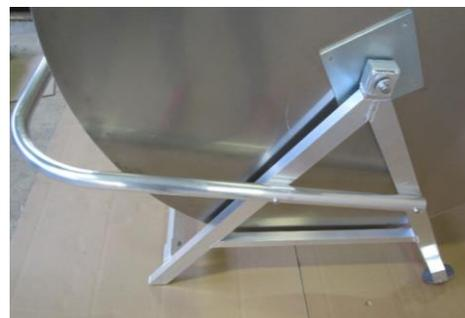
In die Enden des Lenkerbügels nun 2 Stck. Kunststoffkappen rund mit einem Hammer/Gummihammer einschlagen.
