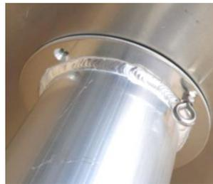
Zur Fixierung der Zapfenplatte nun die Gewindingöse von der Haspelrohrseite durch die unge-senkte Bohrung in Haspelrohrflansch (siehe Foto links) und Seitenteil stecken und lose in die Zapfenplatte einschrauben.
