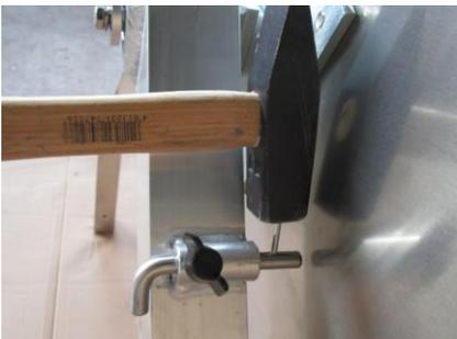
In die Bohrung des Winkelhakens den Kerbstift 3 x 20mm mit einem Hammer/Gummihammer eintreiben, sodass er beidseitig gleichmäßig übersteht.
