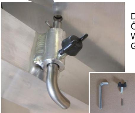
Den Winkelhaken  $\varnothing$  9mm von der Außenseite durch die Öffnung der Hülse stecken. Zur Fixierung des Winkelhakens 1 Stck. Flügelschraube M8 x 16mm in die Gewindebohrung der Hülse eindrehen.
