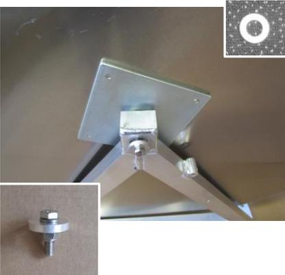
Jeweils 1 Stck. Unterlegscheibe DIN 125-1,  $\varnothing$  außen 28mm auf das vormontierte Schraubelement stecken, dieses in das Gewinde an der Zapfenplatte einschrauben und fest anziehen. Die Haspel muss sich dabei noch freigängig drehen können.
