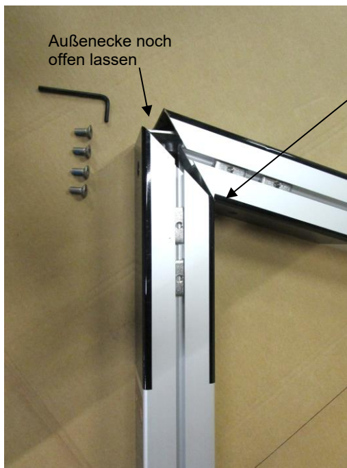
3. Gehrung der Innenecke dicht schieben
