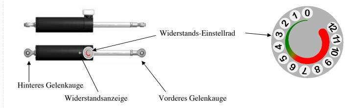
Durch den eingebauten Hydraulikzylinder, den es mit Einfach- oder Doppelfunktion gibt, ist ein nahezu geräuschloses Training mit individuell einstellbarem Widerstand möglich.
