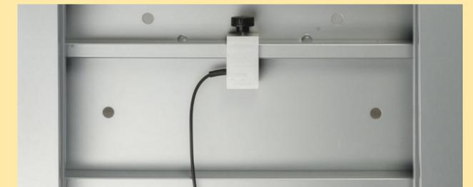
Abb.: Sensorbefestigung Posturomed<sup>®</sup> compact (Unterseite) –
