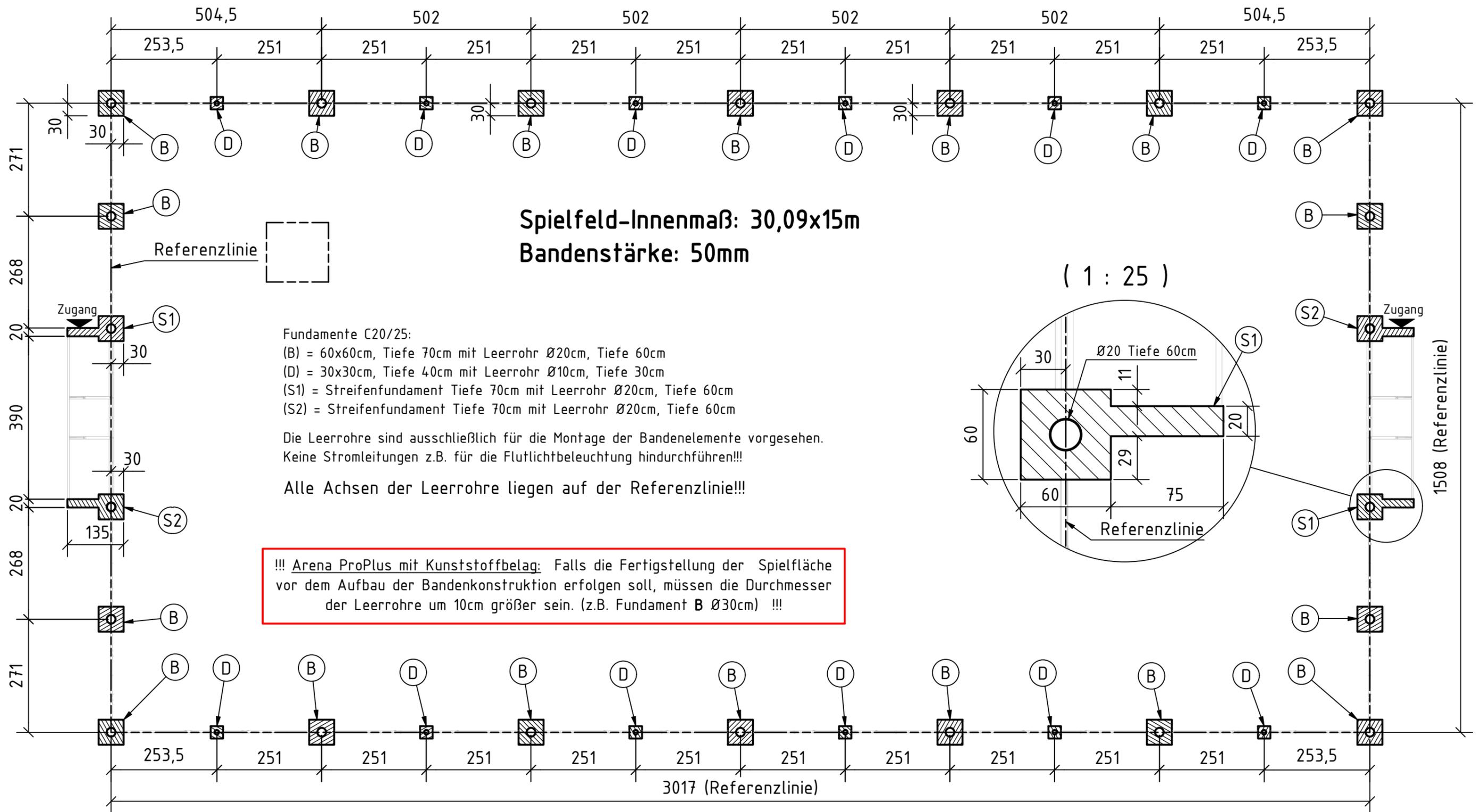
Die Streifenfundamente der Tore müssen auf Oberkante Fertigfußboden liegen. Sollten Kantensteine zur Umrandung oder Ähnliches benutzt werden, so sind diese ebenfalls auf dasselbe Höhenniveau zu setzen.
