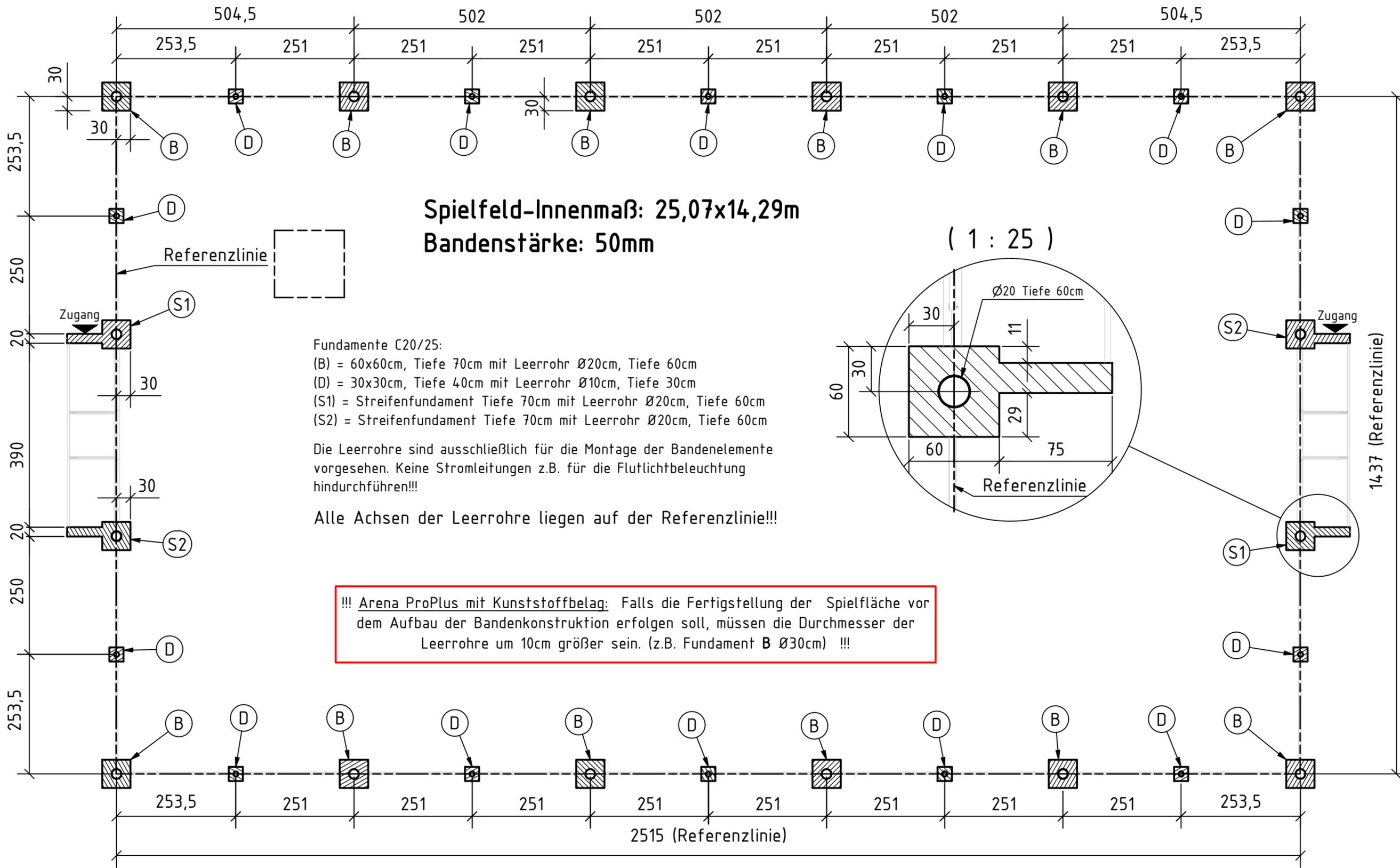
Die Streifenfundamente der Tore müssen auf Oberkante Fertigfußboden liegen. Sollten Kantensteine zur Umrandung oder Ähnliches benutzt werden, so sind diese ebenfalls auf dasselbe Höhenniveau zu setzen.
