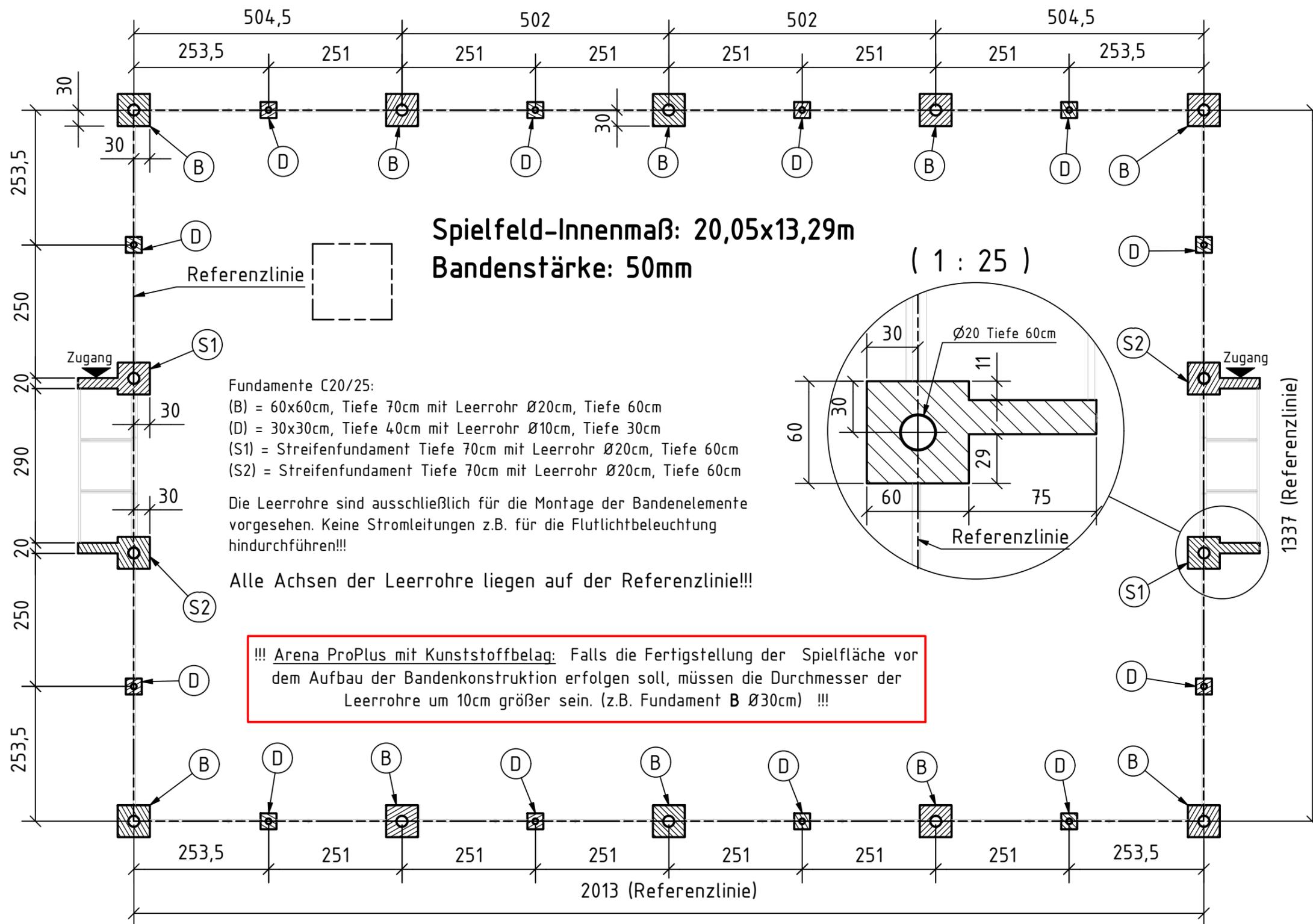
Die Streifenfundamente der Tore müssen auf Oberkante Fertigfußboden liegen. Sollten Kantensteine zur Umrandung oder Ähnliches benutzt werden, so sind diese ebenfalls auf dasselbe Höhenniveau zu setzen.
