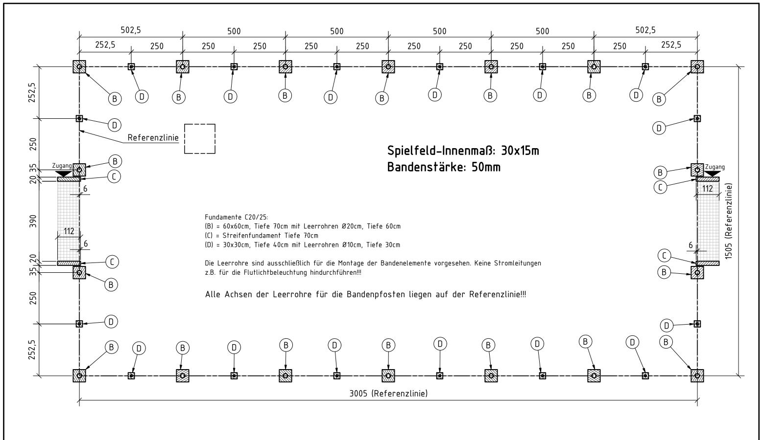
Die Streifenfundamente der Tore müssen auf Oberkante Fertigfußboden liegen. Sollten Kantensteine zur Umrandung oder Ähnliches benutzt werden, so sind diese ebenfalls auf dasselbe Höhenniveau zu setzen.
