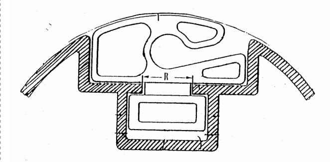
Anstatt Mutterstücke und V2 A Netzhaken werden die Kunststoff-Netzhaken mit einer Zange in die Profilnut eingedreht. Netzhaken bitte nur in dieser Richtung über die abgerundete Ecke drehen. (siehe Skizze)
