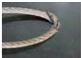
PINCEMENT L'espace entre les fibres où le câble a été pincé.
