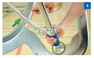
Ziehen Sie nun die Inbusschrauben wieder an, während Sie die Stütze noch gegen den Anschlag drücken.
