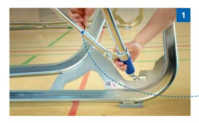
Lösen Sie die beiden Inbusschrauben an dem kleinen Stützrohr.
