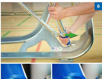
Um die Stütze einrasten zu können, sollten Sie diese am blauen Griff mit etwas Druck neben die Kugel führen, um dann die Kugelpfanne vollständig über die Kugel zu ziehen.
