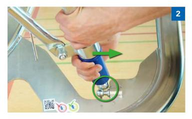
Drücken Sie die Kugelpfanne gegen den Anschlag über der Kugel, bis die Kugelpfanne die Metallplatte berührt.
