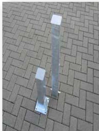
1. **Bodenhülsen „zum Aufdübeln“** entsprechend der Spielfeldgröße auf Betonfundament aufdübeln. Hierbei beachten, dass die Bodenhülsen mit 1° negativ Neigung gefertigt wurden. Auf der Bodenplatte der Bodenhülse ist „Ziffer 1“ eingepreßt. Diese muss beim Aufdübeln nach innen Richtung Netz zeigen.
