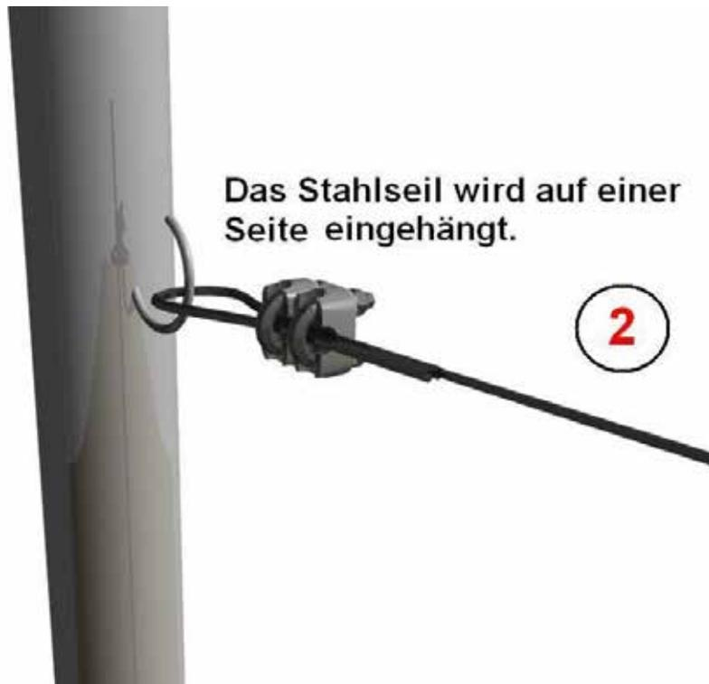
Das Stahlseil wird auf einer Seite eingehängt.
