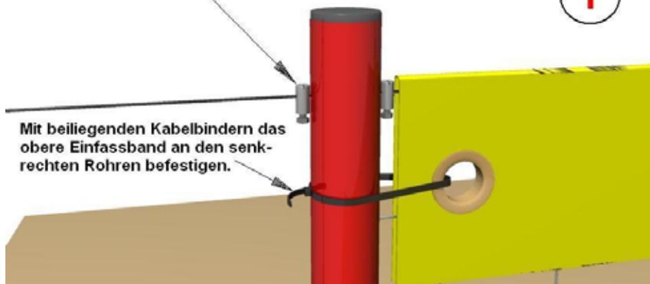
Mit beiliegenden Kabelbindern das obere Einfassband an den senkrechten Rohren befestigen.
