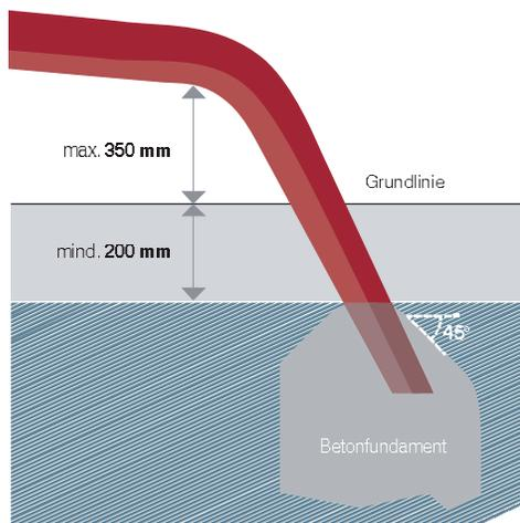
Bild 3 | Ausstiegsteil Betonfundament
