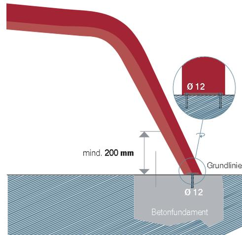
Bild 4 | Ausstiegsteil Verschraubung
