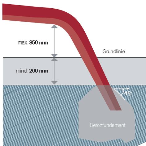
Bild 3 | Ausstiegsteil Betonfundament
