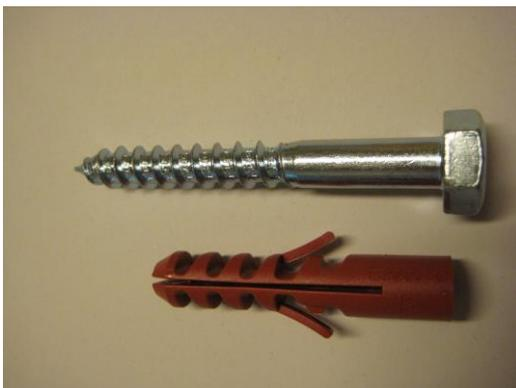
Mit diesen Schrauben und Dübeln werden die Befestigungswinkel an der Wand befestigt. Dazu muss ein ausreichend tiefes Loch mit einer 12er Bohrung in der Wand gebohrt werden.
