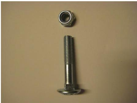
Mit diesen Schrauben wir die Sprossenwand an den Befestigungswinkeln angebracht. Dazu muss die Sprossenwandwange mit einer 8er Bohrung komplett durchbohrt werden.
