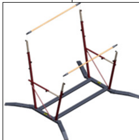
Abb. 9: Zusammenbau von Standrohren und Stufenbarrenholmen
