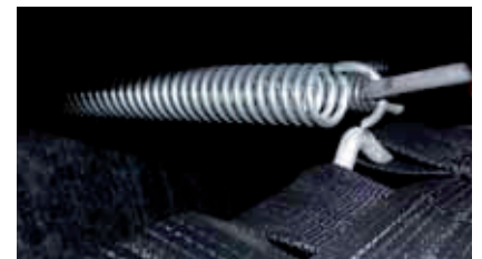
Ein- bzw. Aushängen von Federn mit Einspannhaken
