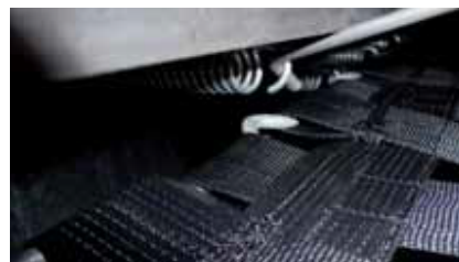
Ein- bzw. Aushängen von Federn mit Einspannhaken
