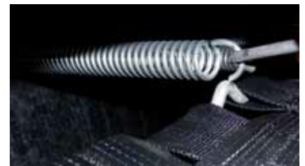
Ein- bzw. Aushängen von Federn mit Einspannhaken
