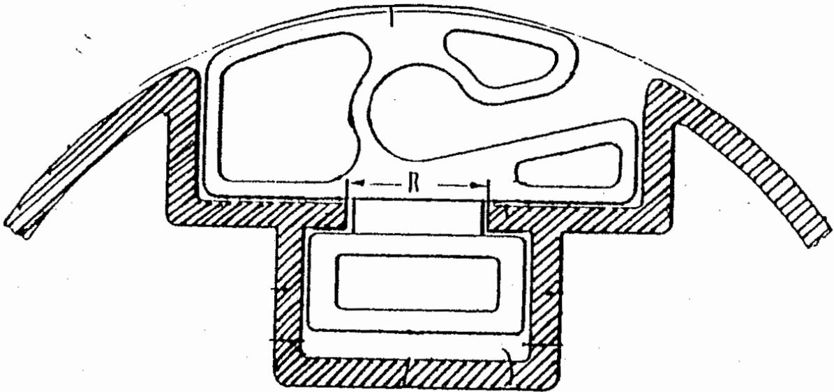
Anstatt Mutterstücke und V2 A Netzhaken werden die Kunststoff-Netzhaken mit einer Zange in die Profilnut eingedreht. Netzhaken bitte nur in dieser Richtung über die abgerundete Ecke drehen. (siehe Skizze)
