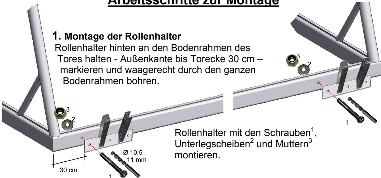
Rollenhalter mit den Schrauben<sup>1</sup>, Unterlegscheiben<sup>2</sup> und Muttern<sup>3</sup> montieren.
