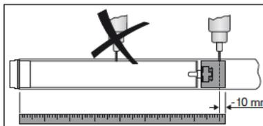
Um den Antrieb gegen axiales Verschieben zu sichern, empfehlen wir den Mitnehmer mit der Welle zu verschrauben.
