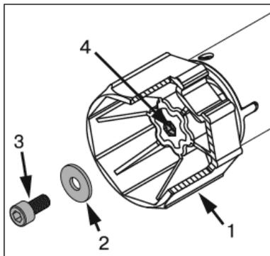
Stecken Sie den Mitnehmer (1) auf die Abtriebswelle des Rohrantriebes auf. Verwenden Sie zur Montage eine Schraube M6x12 (3) mit entsprechender Unterlegscheibe (2) und geeigneter Schraubensicherung. Gewindebohrung (4)
