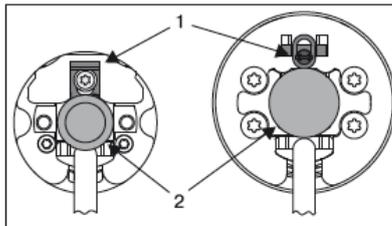
Der Steckzapfen (2) rastet beim Einschieben automatisch ein. Zum Lösen des Steckzapfens (2) das Sicherungsblech (1) nach oben schieben und den Steckzapfen (2) herausziehen.
