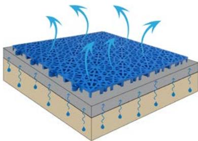
Die Bergo Sportböden verfügen über ein perforiertes Muster und sind durch das Design auf der Unterseite hervorragend wasserableitend, wodurch das Spielfeld nach Regen schnell abtrocknen kann. Keine Pfützen!
