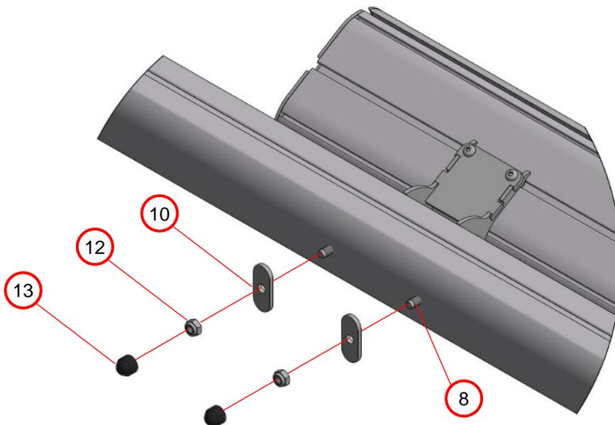
**9.** Die Schlossschrauben (8) durch die Bohrungen im Bodenrahmen schieben. Die Unterlegplatten (10) auf die herausstehenden Schraubenenden schieben und mit den Sechskantmutter M10 (12) sichern.
