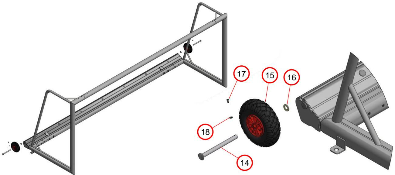
**12.** Die Achse mit Kappe (14) in das Rad (15) stecken und eine Unterlegscheibe KU M20 (16) aufschieben.
