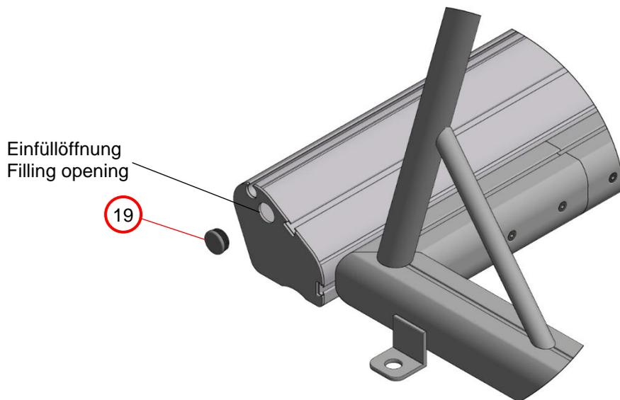
Über die Einfüllöffnung wird das Gewichtsrohr von beiden Seiten mit den Rundstählen Ø20mm befüllt.
