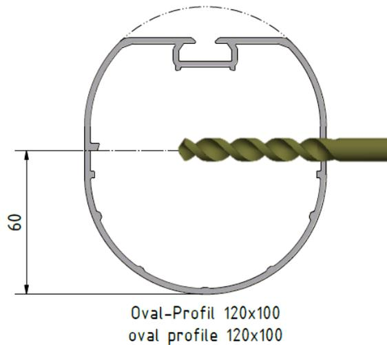
**8.** An den markierten Stellen im Abstand von 60mm von unten mit einem 6mm Metallbohrer vorbohren und danach mit einem 11mm Bohrer die Bohrungen aufbohren.
