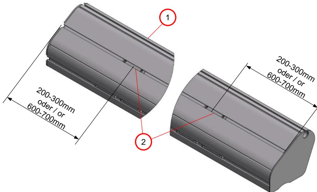
**Hinweis:** Bei vollverschweißten Toren müssen die Nutensteine einen Abstand von 200-300mm zur Außenkante des Gewichtsrohrs (1) haben.
