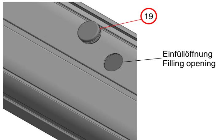
Über die Einfüllöffnungen wird das Gewichtsrohr mit trockenem Quarzsand befüllt (z.B. mit Hilfe eines Trichters). Dazu das Tor leicht nach hinten kippen, damit die Einfüllöffnungen genau nach oben zeigen.
