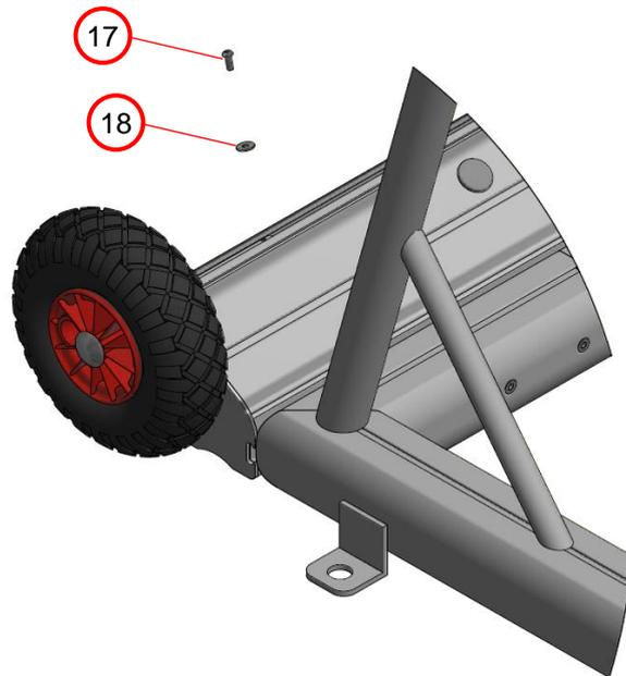
**13.** Die Ache in die Profilnut des Gewichtsröhrs (1) schieben und mit der Linsenkopfschraube M6x16 (17) und der Unterlegscheibe M6 (18) sichern.
