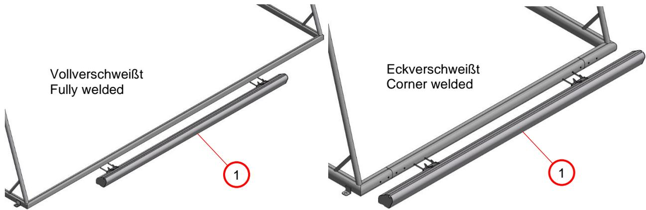
**6.** Das Gewichtsrohr mittig hinter dem Bodenrahmen platzieren.
