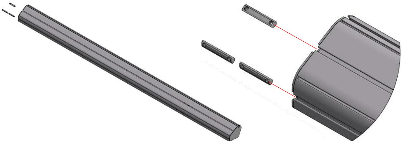
Alternativ können die Nutensteine doppelt M8 auch seitlich in die Profilnut des Gewichtsrohrs eingeschoben werden.
