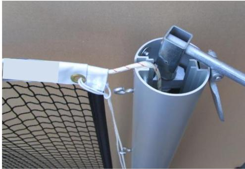
Dann den Seilhaken durch Verwendung des Schlüssels soweit nach unten drehen, bis die gewünschte Netzspannung erreicht ist. Sollte nicht genügend Spannung aufgebracht werden können, bitte den nachfolgenden Pkt. c) beachten.
