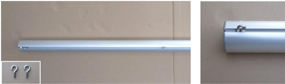
Im nächsten Schritt auf der Gegenseite des Pfostens 1 Stck. Einsteckmutter M8 in die Nut einschieben und unterhalb der Abdeckkappe platzieren (siehe Foto unten). Dann 1 Stck. Winkelhaken M8 in die Einsteckmutter eindrehen, so dass der Haken zum offenen Pfostenende zeigt.
