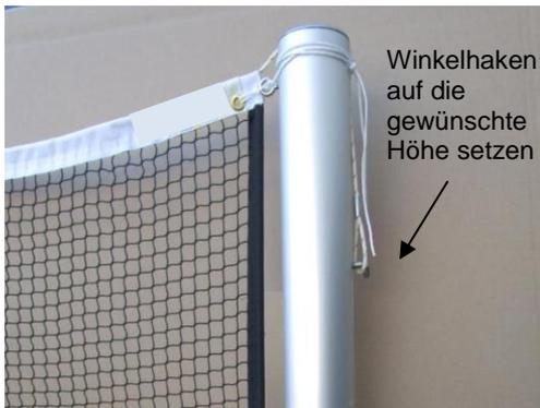
Bei zu geringer Netzspannung kann der Winkelhaken am Gegenpfosten versetzt werden. Zunächst das Seil am Mechanikpfosten wieder komplett entspannen. Dann das Spannseil aushängen, den Winkelhaken losschrauben, nach unten in die gewünschte Position schieben und wieder fest anziehen. Dann das Spannseil wieder einhängen und den Spannvorgang am Mechanikpfosten wiederholen.
