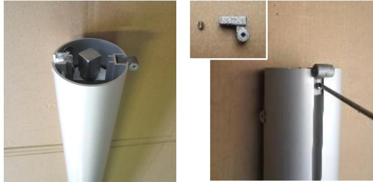
Die Abdeckkappe am Halteklötz mit 1 Stck. Flachkopfschlitzschraube DIN 84, M4 x 40mm und selbstsichernder Mutter DIN 985, M4 befestigen. Ggf. den Halteklötz nochmals ausrichten und anschließend den Gewindestift fest anziehen.
