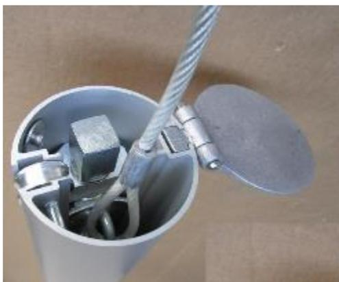
Das Spannseil über die Umlenkrolle führen und am Seilhaken einhängen.
