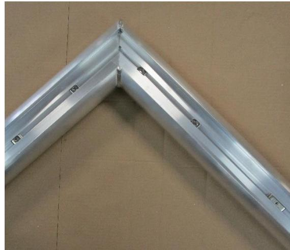
Elemente f. Verbindung Pfosten / Latte
