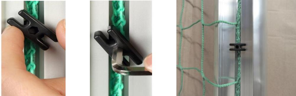
Die Spannleine durch jede Masche des Netzes führen und an den Außenseiten und am Netzbügel festknoten, ggf. durch die Bohrung im Netzbügel führen.
